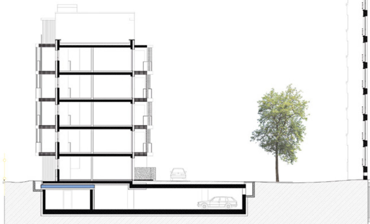
Querschnitt Tiefgarage mit 150 Parkplätzen
